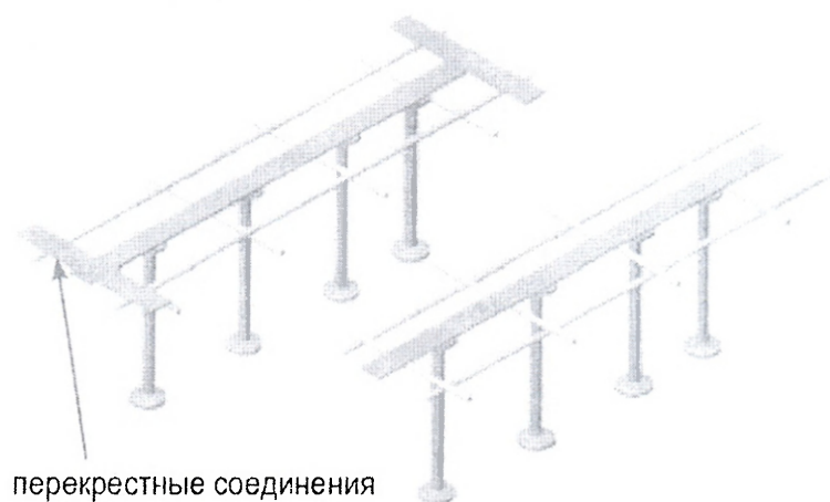
Рисунок 129 – Элементы PSB с перекрестными стальными пластинами
